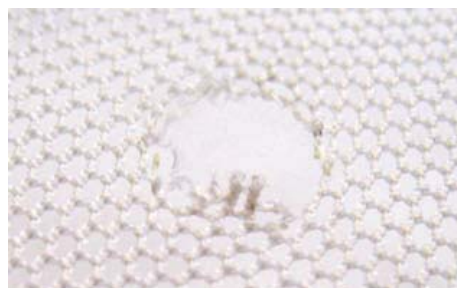
Abbildung 17 PowerNet hält Laufmaschen stand und erzeugt eine ausreichende Kompression auch dann, wenn die Struktur geschädigt wurde
