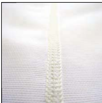
Abbildung 22 Die Flatlock-Naht ist fest, liegt flach am Körper an und ist unter Kleidung nicht zu sehen
