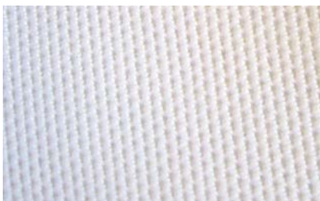
Abbildung 16 PowerNet-Stoff besteht aus einer flexiblen, atmungsfähigen, offenen Sechseck-Konstruktion
